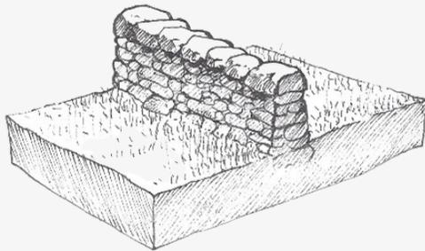
Mur constitué d'un parement de chaque côté, d'un remplissage et d'un couronnement qui a pour rôle de protéger le mur d'une dégradation par le haut qui pourrait se propager dans l'ouvrage entier.
