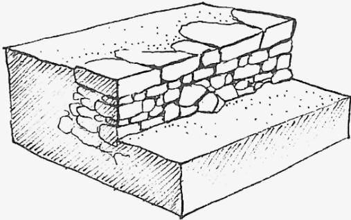
Mur constitué d'un parement extérieur, d'un remplissage, d'un parement contre la terre et d'un couronnement.
